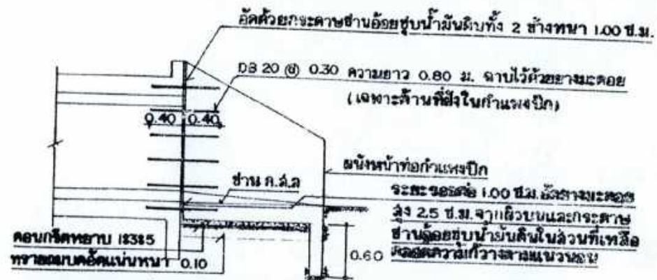
รายละเอียดเกี่ยวกับรอยต่อผนังท่อน้ำและปีกกำแพง
